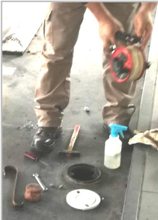
Ilustración 6: Medición de niveles freáticos
